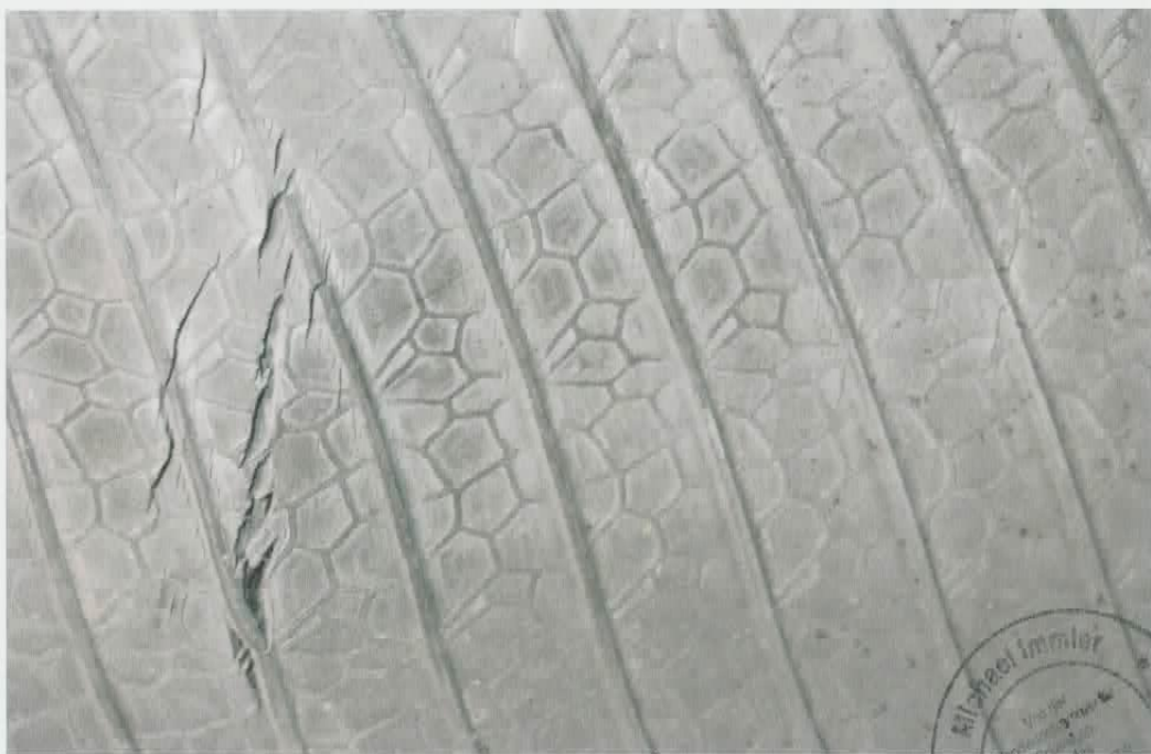
Innerliner eines Reifen Continental mit deutlichen Überlastmerkmalen. Die Leistung des Reifens und die Struktur des Innerliner sind vergleichbar. Die Restprofiltiefe ist ebenfalls vergleichbar mit der des oben abgebildeten Reifen
